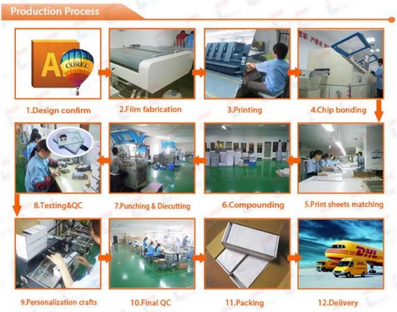
RFID 印刷製程
