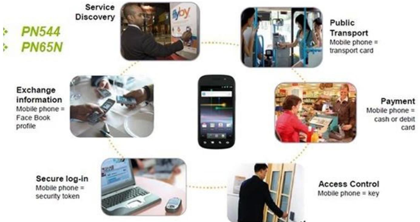
La communication en champ proche (NFC) est un ensemble de normes pour les smartphones et les appareils similaires permettant d'établir une communication radio entre eux en les touchant ou en les rapprochant, généralement pas plus de quelques centimètres.
